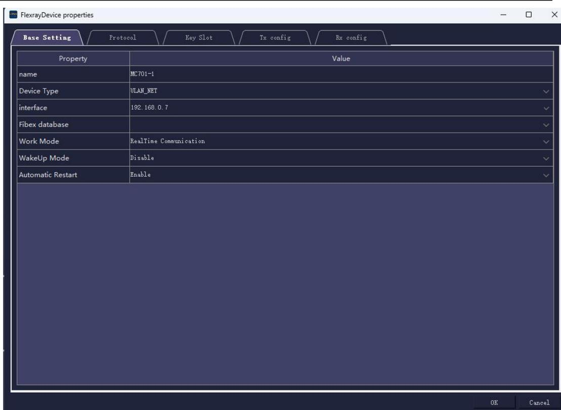
图 5.FlexrayDevice 属性 Base Setting 配置页面
