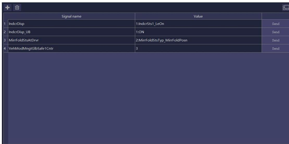
图 25. FlexraySignalSender 组件操作页面
