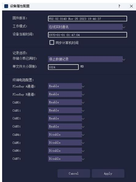
图 53. 终端电阻配置界面
