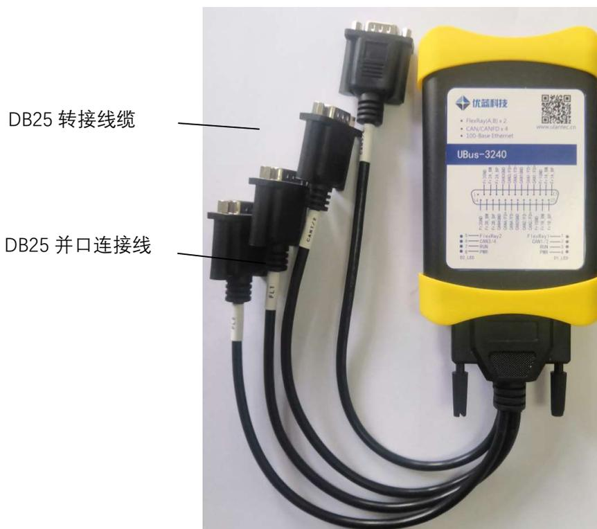
图6 DB25 转接线缆使用说明实物图
